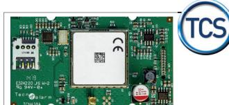
L'interfaccia ESP GSM 4G è compatibile con i sistemi TP10-42, TP8-88 e TP20-440 di Tecnoalarm a partire del firmware ver. 1.9.21. Essa si inserisce direttamente sulla scheda CPU e permette l'uso delle reti 2G, 3G e 4G come vettore di comunicazione. La programmazione si effettua tramite il software Centro (tabelle di configurazione sezione telefonica -> GSM).
